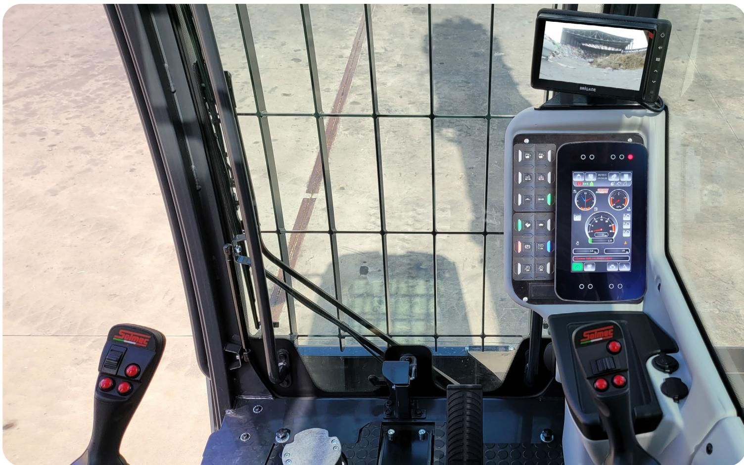
Strumentazione completa con display a colori da 7" e promemoria per i tagliandi di manutenzione. Il computer di bordo visualizza inoltre le funzioni del "OWD" (Overload Warning Device) per tenere sempre sotto controllo il carico movimentato. Nuovi joysticks elettronici con roller proporzionali per il controllo preciso della rotazione della benna e della salita e discesa di lama e staffe. Per una migliore visibilità, in opzione è disponibile lo sterzo sui joysticks
