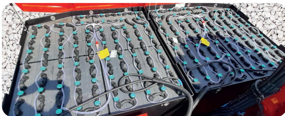
Ciascuna delle 2 batterie ad alta efficienza è composta da 60 elementi per un'erogazione di 120 V a 930 Ah, garantendo una durata di circa 8 ore di lavoro.
