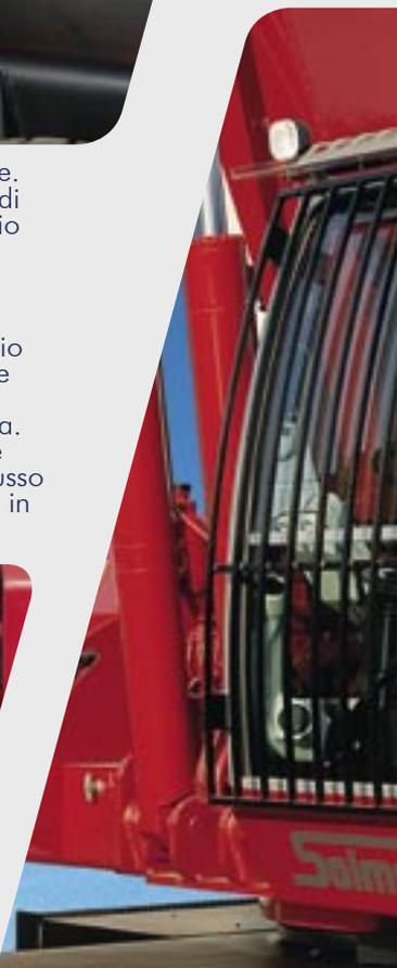
**La cabina di guida** a sollevamento idraulico a parallelogramma permette di raggiungere i 5,25 m di altezza occhio operatore, consentendo un'ottima visuale anche dentro i cassoni dei camion o dentro i vagoni ferroviari.
