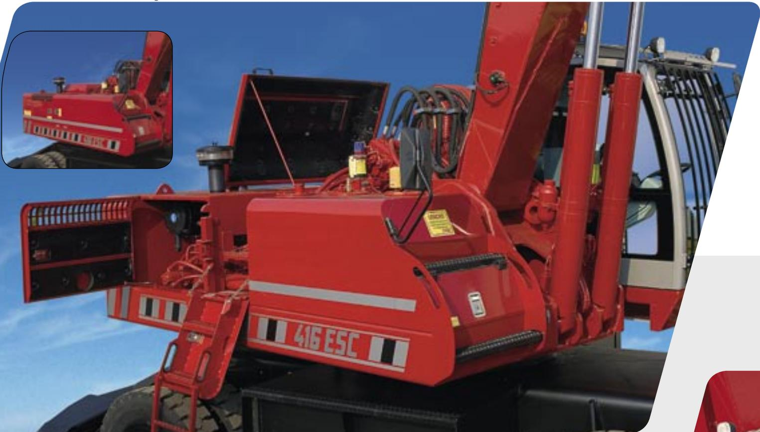
Ottima accessibilità al **vano motore** con scaletta di accesso per semplificare le operazioni di manutenzione. Cofanature rivestite internamente con materiale fonoimpedente (poliuretano espanso con sottile lamina di piombo per trattenere le onde sonore) per ridurre la propagazione esterna del rumore. Feritoie per il passaggio dell'aria rivolte verso l'alto per deviare flussi d'aria e rumorosità lontano dall'altezza uomo.
