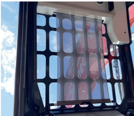
Tendina parasole avvolgibile sul tetto con tergicristallo.
