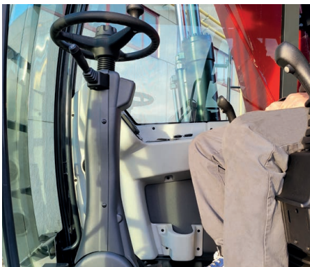
Colonna dello sterzo orientabile ...
