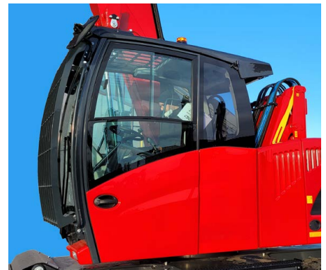
Cabina di guida con ampie superfici vetrate e finestrino laterale sinistro apribile a scorrimento.
