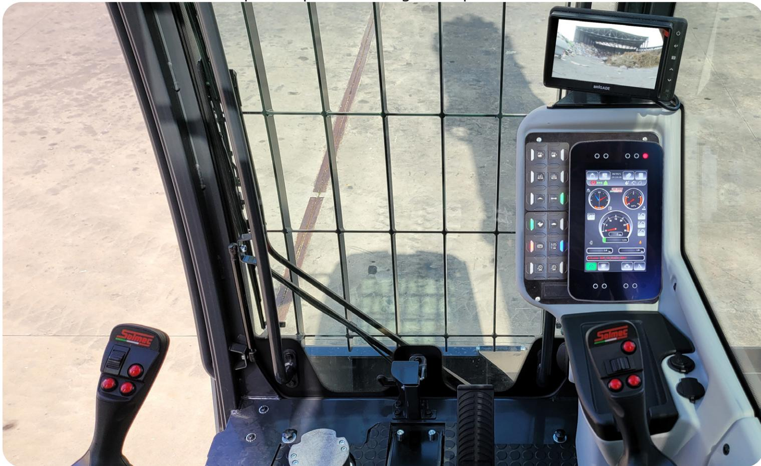
Strumentazione completa con display a colori da 7" e promemoria per i tagliandi di manutenzione. Il computer di bordo visualizza inoltre le funzioni del "OWD" (Overload Warning Device) per tenere sempre sotto controllo il carico movimentato. Nuovi joysticks elettronici con roller proporzionali per il controllo preciso della rotazione della benna e della salita e discesa di lama e staffe. Per una migliore visibilità, in opzione è disponibile lo sterzo sui joysticks
