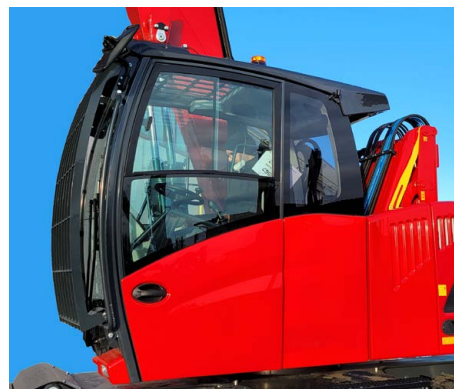
Cabina di guida con ampie superfici vetrate e finestrino laterale sinistro apribile a scorrimento.
