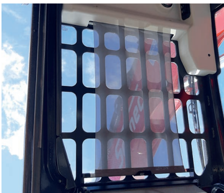
Tendina parasole avvolgibile sul tetto con tergicristallo.
